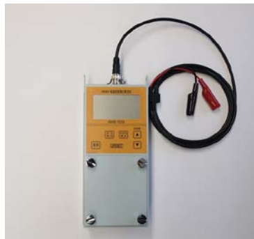
電圧測定 (BNC ケーブルを取付けます)
