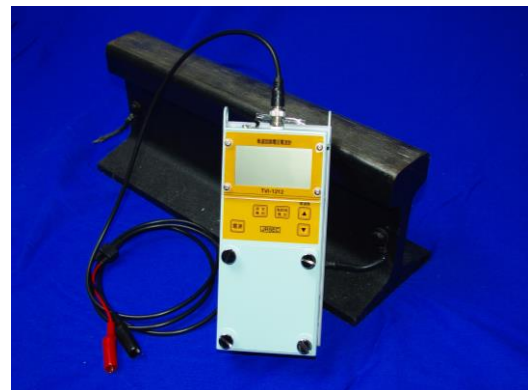
電圧測定(BNC ケーブルによる)
